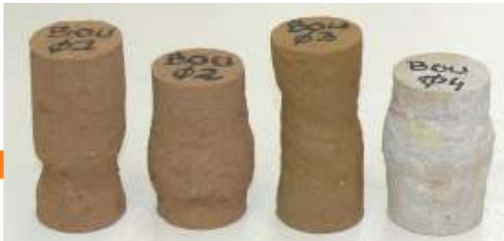
Exemples d'éprouvette après essais
