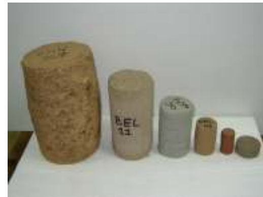
Eprouvettes triaxiales 38 à 150 mm
