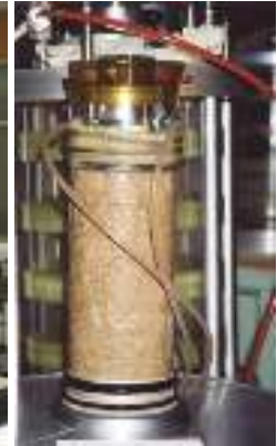
Éprouvette triaxiale (diamètre 76 mm)
