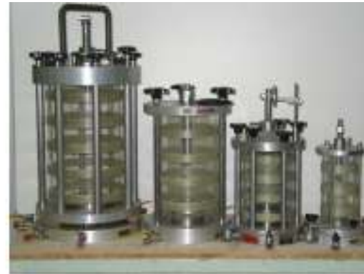
Cellules triaxiales 50 à 150 mm
