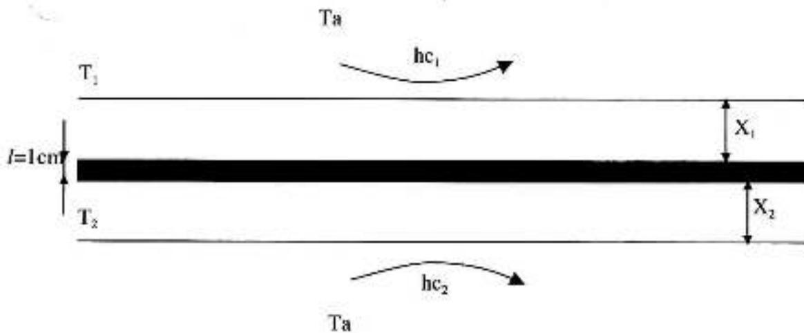
pour  $T_1 = 29^\circ\text{C} = \frac{302,4}{303,4} \text{K} \rightarrow M = \epsilon \sigma T_a^4 = 0,9 \times 5,68 \times 10^{-8} \times 302,4^4$
