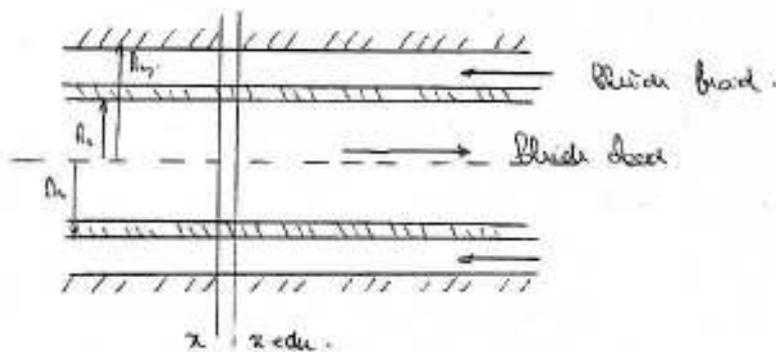
Bilan thermique pour le fluide chaud entre  $x$  et  $x+dx$ .
