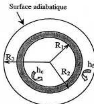
Calculer le coefficient d'échange par convection  $h_c$  côté fluide chaud sachant que les caractéristiques moyennes du fluide chaud sont les suivantes : la conductivité thermique avec  $\lambda_c = 0,568 \text{ W.m}^{-1}.\text{K}^{-1}$ , la masse volumique avec  $\rho = 997,7 \text{ kg.m}^{-3}$ , la chaleur massique avec  $c_c = 4183 \text{ J.kg}^{-1}.\text{K}^{-1}$  et la viscosité cinématique avec  $\nu = 0,413 \cdot 10^{-6} \text{ m}^2.\text{s}^{-1}$ .
