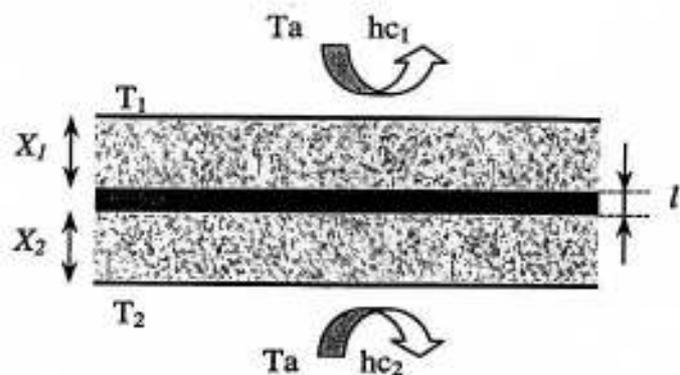
1 - Les résistances thermiques surfaciques des zones comprises entre l'élément chauffant et l'ambiance :  $R_1$  pour la partie supérieure et  $R_2$  pour la partie inférieure.
