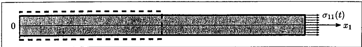
FIG. 1 – Traction uniaxiale d'un ruban déformable
