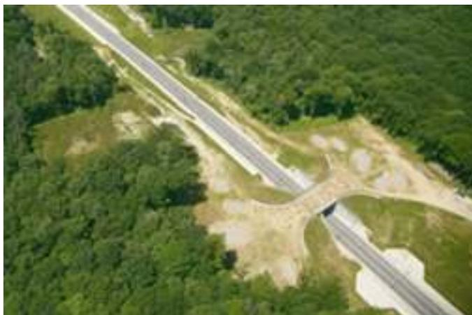
Figure 78 - Exemple d'un passage de faune
