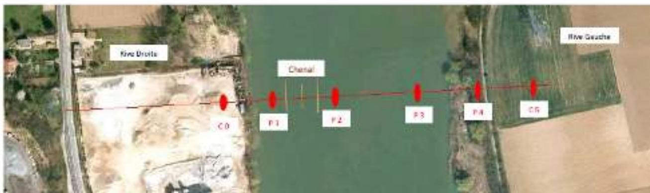
Figure 95 - Profil en long et implantation des piles du tablier
