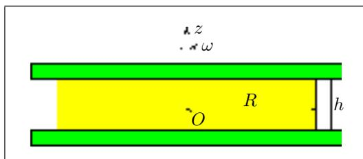
FIG. 1 – Viscosimètre plan-plan
