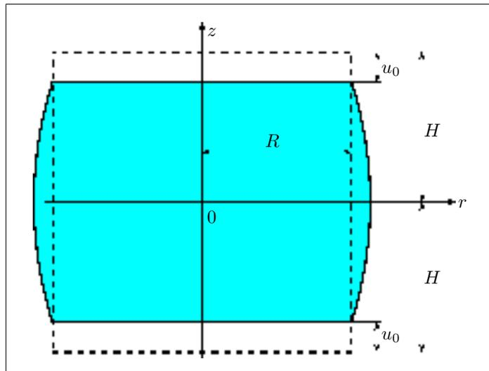
FIG. 1 – Essai de compression fretté
