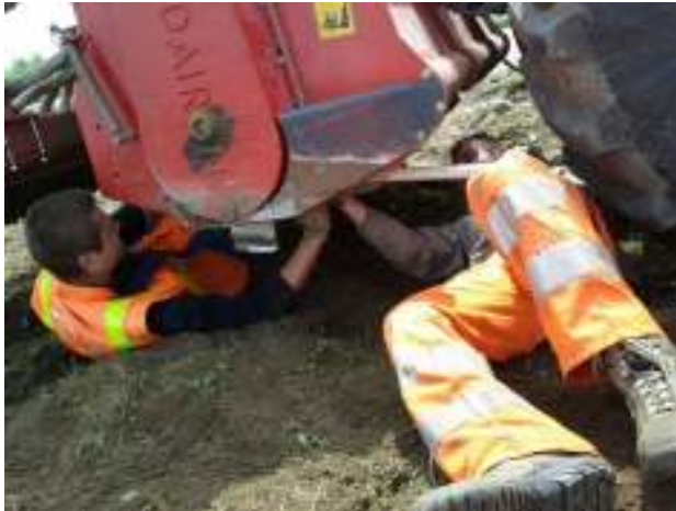
Photo 5 - Agents en train de réparer une machine sur place, préoccupés à dégager cette barre de fer qui s'est engagée entre les couteaux.
