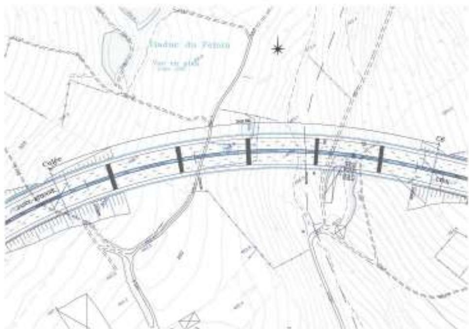
Figure 6 : Profil en en plan de la solution à 6 portées
