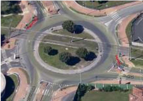
FIGURE: Faible distance entre l'entrée du giratoire et la plateforme tramway.
