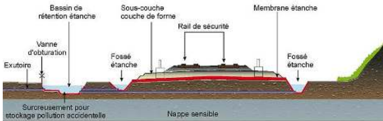
Fig.9 : Coupe schématique du principe d'assainissement en zone sensible forte
