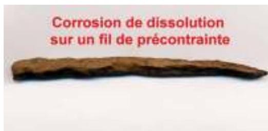
Photo n° 42 : fil de précontrainte du pont de Bamako ayant subi une corrosion dissolvante (photo DP)
