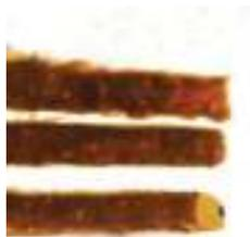
Lunule de corrosion sous tension
