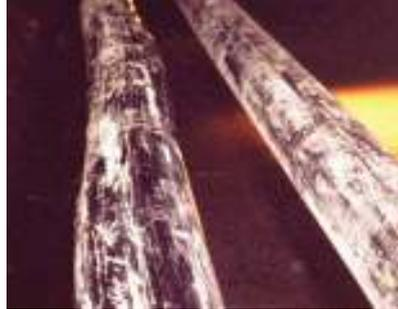
Photo n° 57 : exemple de gaine déformée (photo LRPC)
