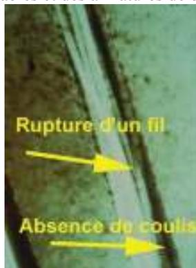
**Photo n° 54 : radiographie d'un câble de BP (d'après un document de l'IFSTTAR)**
