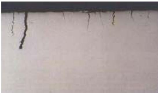
Photo n° 44 : fissures de corrosion sous tension sur le fil d'un toron (photo LRPC de l'Est Parisien)
