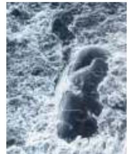
**Photo n° 11 : ettringite pathogène sur un granulats (d'après un document de l'IFSTTAR)**
