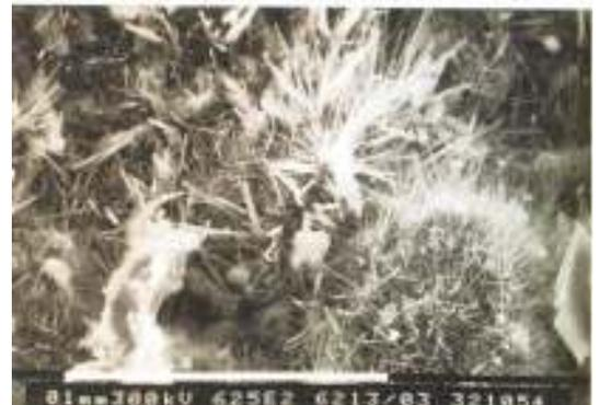
Photo n° 1 : aiguilles d'ettringite non pathogènes (d'après un document de l'IFSTTAR)
