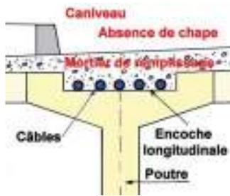
Figure n° 42 : disposition des câbles du pont d'E.
