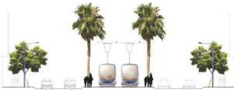
L'illustration est celle proposée par l'architecte du tramway de Casablanca [5] : le tramway se positionne au centre de la chaussée, les voies routières et piétonnes sont respectées, seul le nombre de voies routières et la taille des
