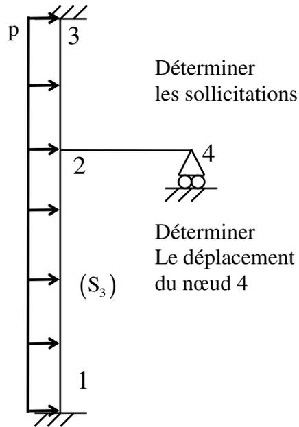
Cinématique :  $\Omega_2, \Omega_4, \Omega$  rotation d'ensemble de la poutre 1-2
