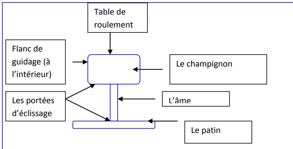
Traçabilité des rails : dans l'âme il y a des inscriptions qui permettent d'identifier le rail. On y trouve la référence du constructeur, la date de fabrication, le profil du rail et le procédé de fabrication.
