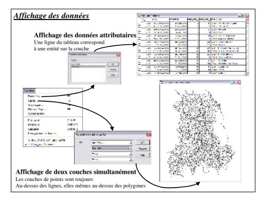
Rappel: lorsqu'une table raster est ajoutée dans une fenêtre carte, c'est elle qui impose sont système de projection. Si les autres tables sont dans un système différent, le logiciel les projette à la volée.
