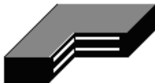
Figure 23 : Schéma d'un appareil d'appui
