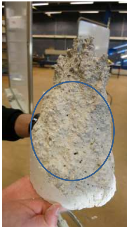
Figure 2: Granulats intacts après essai de compression
