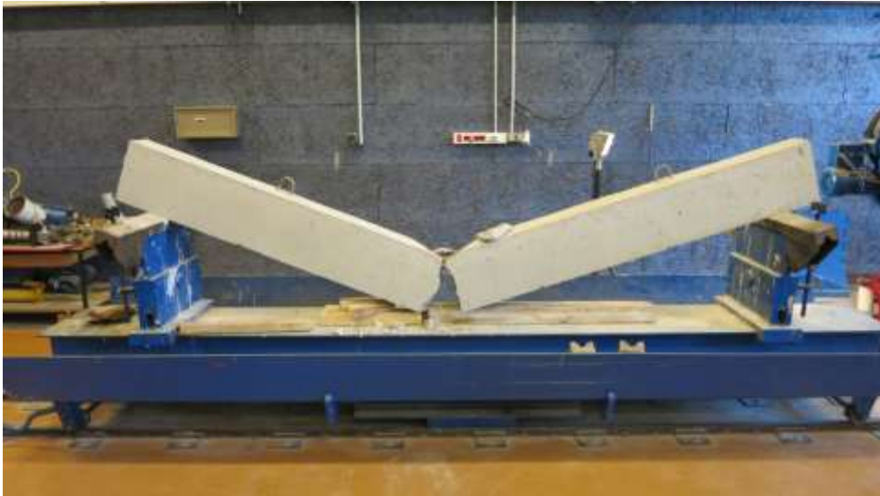
Figure 10: poutre en béton armé après rupture du ferrailage sous dimensionné
