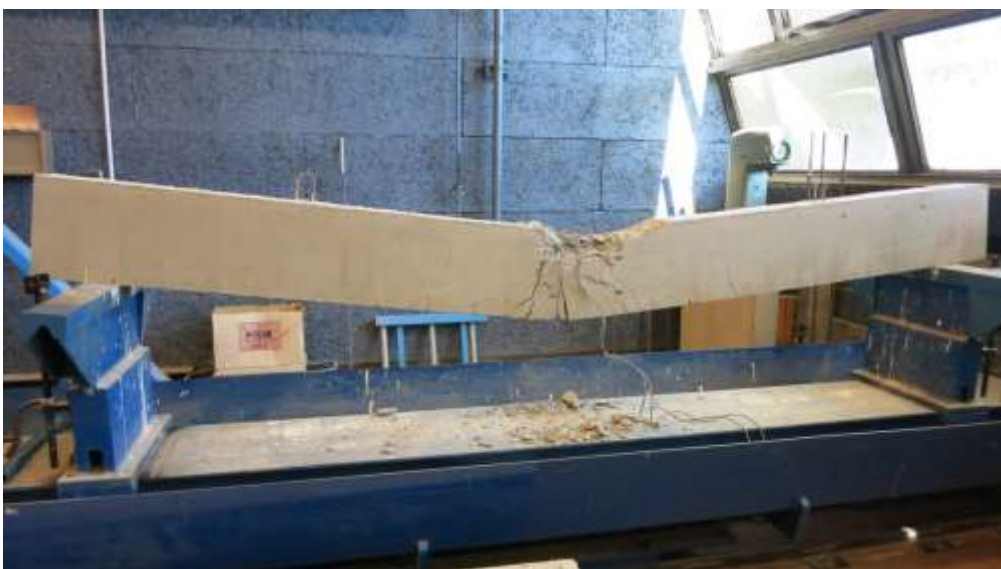
Figure 9: poutre béton armé en un seul morceau exerçant toujours sa fonction de portance grâce à un ferrailage adapté
