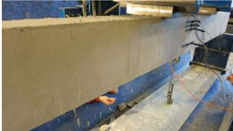
Figure 7: propagation des fissures en direction des extrémités de la poutre
