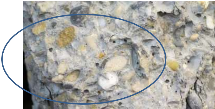
Figure 3: Granulats arrivés à rupture après essai de compression
