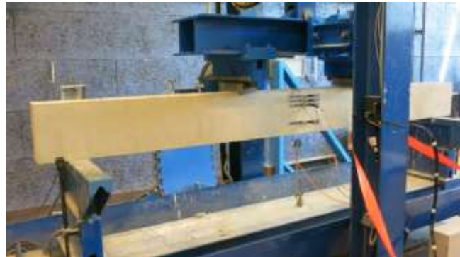
Figure 1: Disposition de capteurs sur la poutre testée
