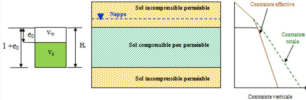
Si l'on applique au temps  $t = 0$  sur un *sol fin saturé*, une distribution de charge constante, le sol a tendance à subir des variations de volume. Mais le sol étant saturé et l'eau ne pouvant s'évacuer du fait de la faible perméabilité des terrains, les variations de volume n'ont pas lieu et elles se traduisent par des surpressions  $\Delta u$  de l'eau interstitielle au voisinage des points d'applications de charges.
