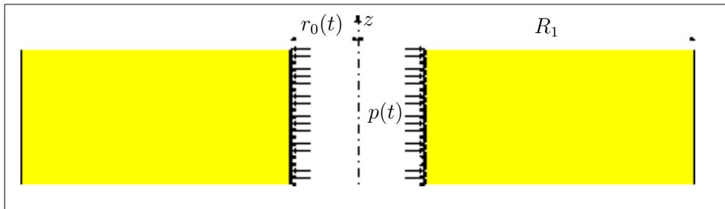
FIG. 1 – Cylindre creux infini sous pression : configuration déformée à l'instant  $t$
