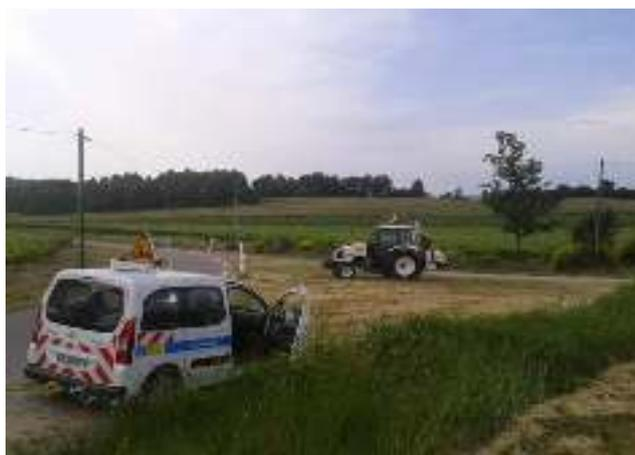
Figure 1.1 : Girobroyeur de fauchage avec véhicule de protection
