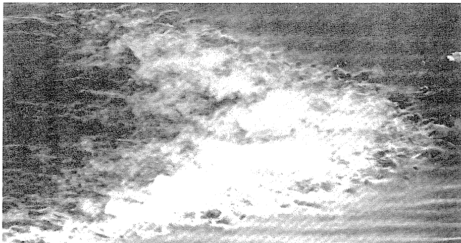
Photographie 4 Instabilité de couche limite le long d'une plaque. Remarquer les zones turbulentes et les parties laminaires (photo R.E. Falco).
