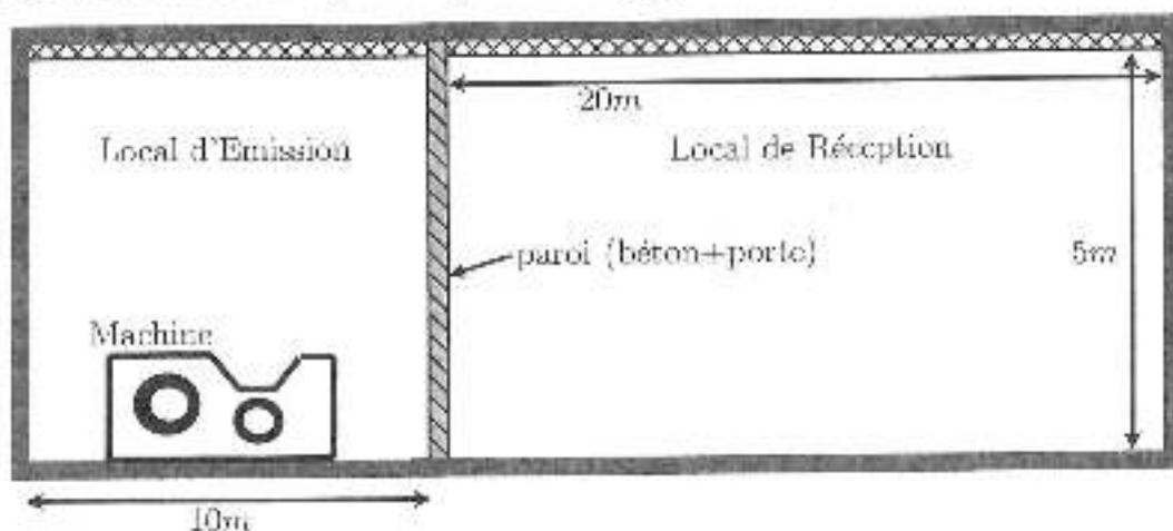
FIGURE 1 Schéma du Hall avec machine présente dans la salle de gauche.
